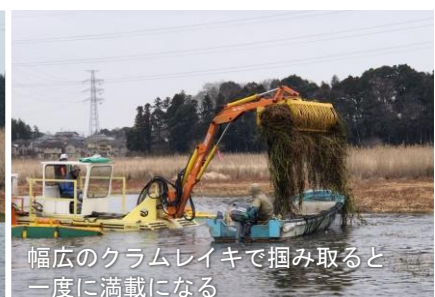
クラムレイキで掴み取ったら水中に振り入れ、泥を除去
