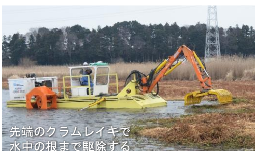
クラムレイキで掴み取ったら水中に振り入れ、泥を除去
